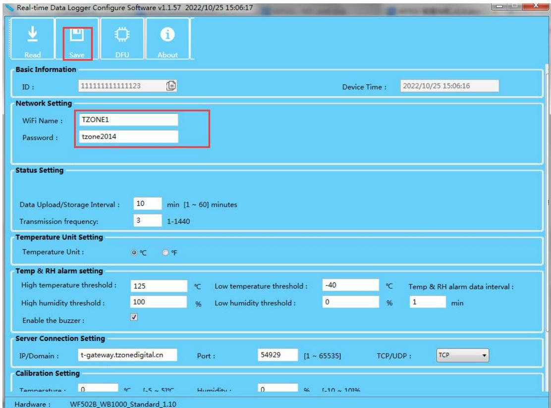
4. 如若需要升级机器的固件，点击“DFU”，然后根据我司的“配置软件升级说明步骤”进行升级
