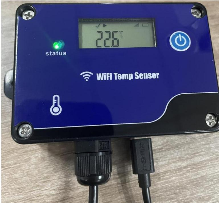
3. 通过 USB 线将设备连接到电脑，点击“读取”读取设备信息（如果设备无法读取，请重新连接 USB 线），在“网络设置”栏中输入本地 WiFi 的账号和密码——点击“保存”保存配置。
