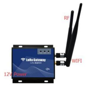
2. 向左往 ON 的方向打开开关, 3 个 LED 灯开始闪烁, 机器开始运行;
