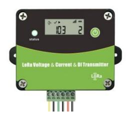
2. 按照使用步骤设置 Lora 网关, TAG11 不需要做任何其它设置, 默认已经开机, 并且每 15 分钟会自动发送一条数据给 Lora 网关, 如需快速发送数据到网关, 可直接按一秒按钮;
