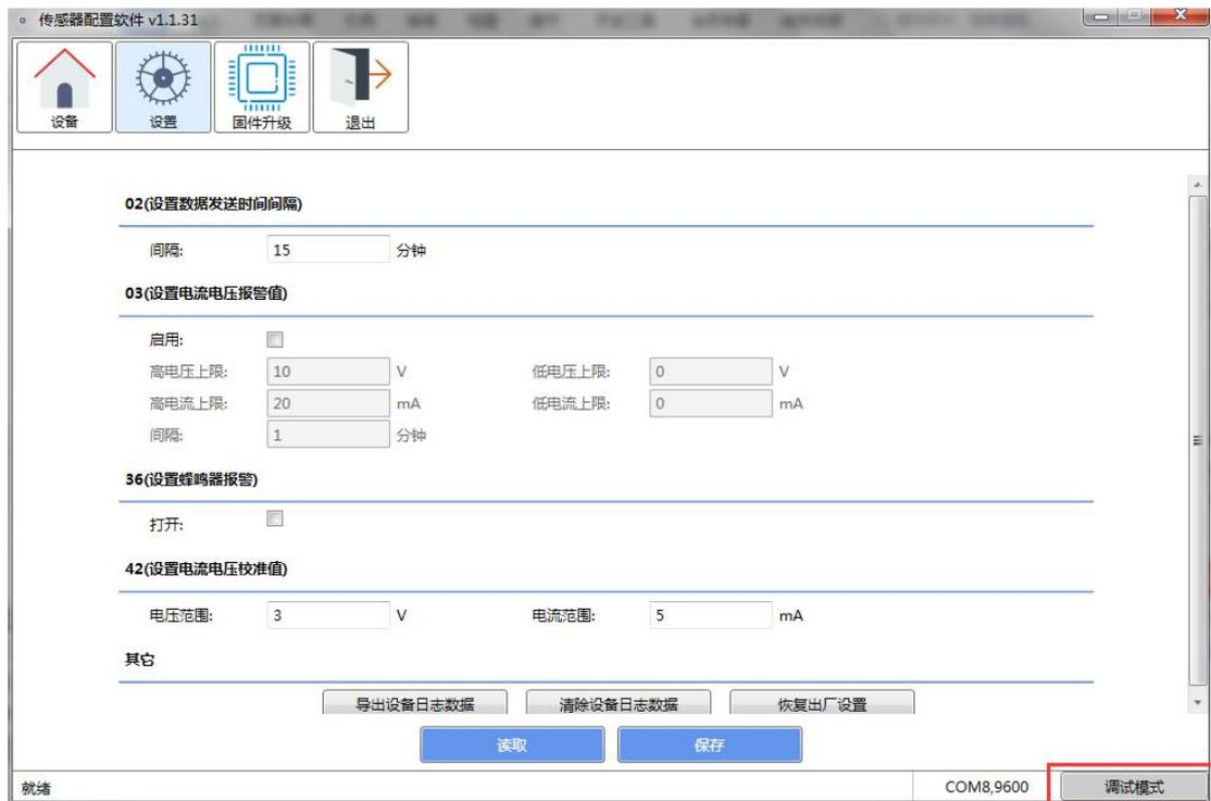
(2) 在调试模式直接通过指令配置机器参数:
