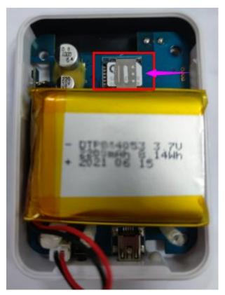
3. 确认 SIM 卡是否需要设置 APN,无需设置 APN 请跳过此项,如需设置 APN 请通过 USB 配置线连接电脑,并设置机器的 APN,也可进行其它参数配置
