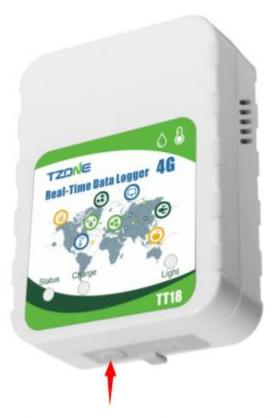
5. 机器开始运行,在温湿度平台上可查看实时的机器温湿度数据,默认 30 分钟发送一次数据,短按一次机器按钮可立即发送一条数据到服务器
