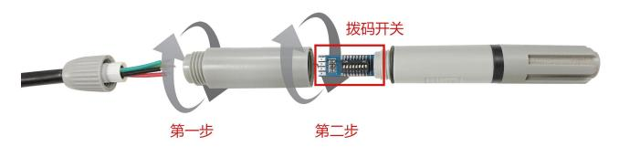
上图是打开拨码开关的正确步骤示意图,请您按照上面步骤打开拨码开关设置地址
