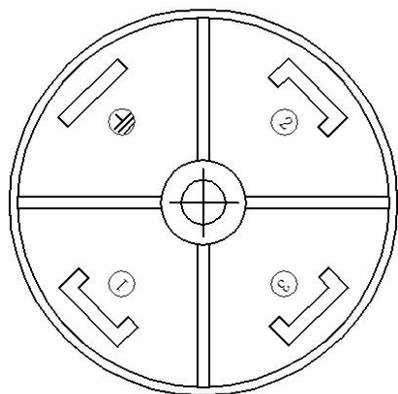
1: 24V+    2: 24V-    3: Out (输出电压信号正极)
